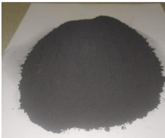
Рисунок 2.1- Концентрат флотации месторождения Васильевское
